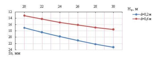
**Рис. 8.** График зависимости дополнительной осадки от глубины траншеи  $S_3=f(L_0)$  при  $L_0=2$ ,4 м;  $L_3/L_0=0$ ,25;  $H_3=20$  м; a/d=2,0
