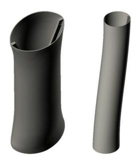
**Рис. 1.** Схематичное изображение колонн в процессе деформирования: a) – труба с двойным диагональным ребром; б) – труба с одним диагональным РЖ
