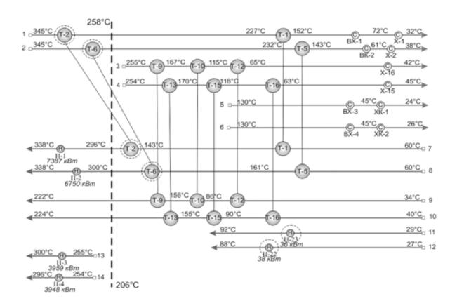
**Рис. 1.** Сеточная диаграмма исходной системы теплообмена Л-24-6. Горячие потоки – слева направо; холодные потоки – справа налево; С - водяные холодильники и ABO; *H* - печи и паровые подогреватели
