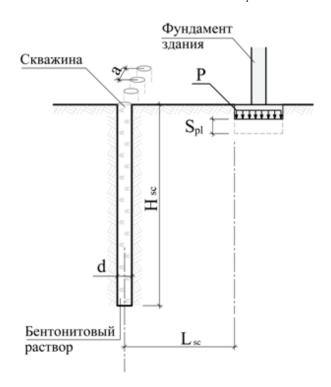
**Рис. 1.** Расчетная схема расположения скважин для последующего устройства разреженного ряда свай геотехнического экрана
