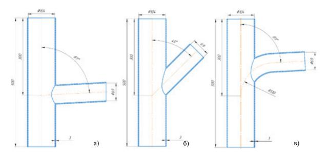
**Рис. 1.** Эскизы расчетных объектов: а) 87°; б) 45°; в) радиальный 87°
