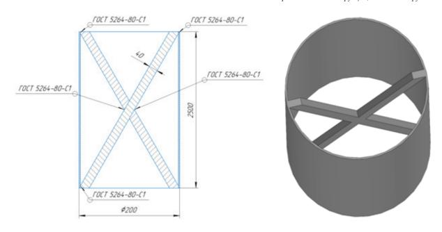
Рис. 1. Схематичное изображение колонны (а) и ее твердотельная модель (б)
