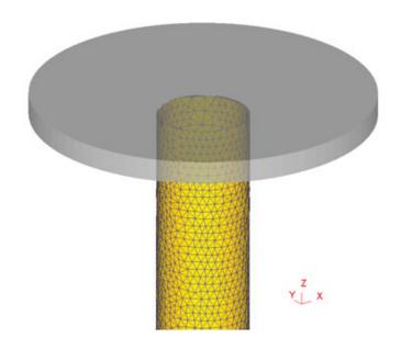
**Рис. 2.** Разбиение трубы на тетраэдральные конечные элементы в *DeForm 3D*
