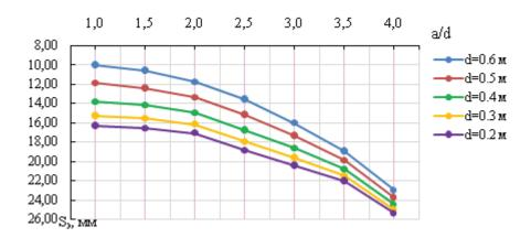
**Рис. 3.** График зависимости дополнительной осадки от относительного расстояния между сваями экрана  $S_3 = f(a/d)$  при  $H_3/H_{\rm T} = 1,0; L_3/L_0 = 0,35$
