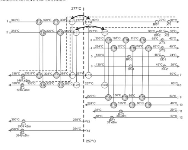
Рис. 3. Сеточная диаграмма интегрированной системы теплообмена с утилитными путями
