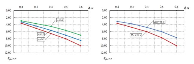
**Рис. 2.** График зависимости дополнительной осадки  $S_{pl} = f(d)$  при  $L_{sc} = 2$  м, E = 15 МПа в зависимости от: а) их относительного расстояния a/d; б) глубины скважин  $H_{sc}$
