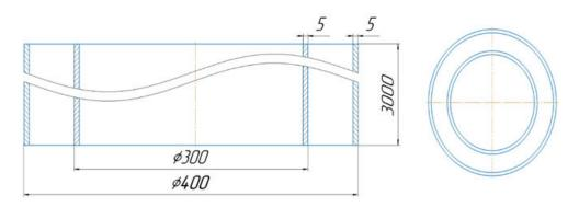
Рис. 1. Эскиз двойной трубы: а) – вид спереди; б) – вид сверху
