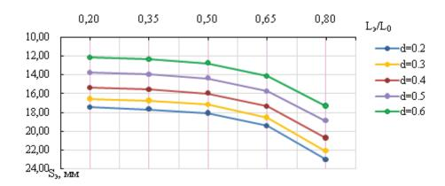
**Рис. 6.** График зависимости дополнительной осадки от относительного расстояния экрана  $S_9 = f(L_3/L_0)$  при  $H_3/H_{_{
