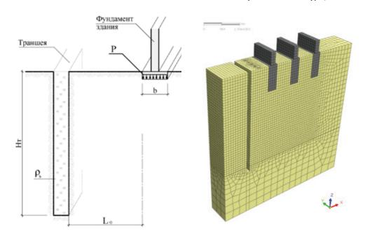
**Рис. 1.** Разработка траншеи без защитного экрана: a) – расчетная схема; б) – конечно-элементная модель
