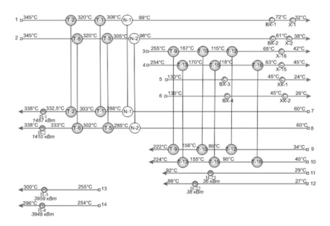
**Рис. 4.** Сеточная диаграмма проекта реконструкции синтезированная методом *SELOOP*-анализа
