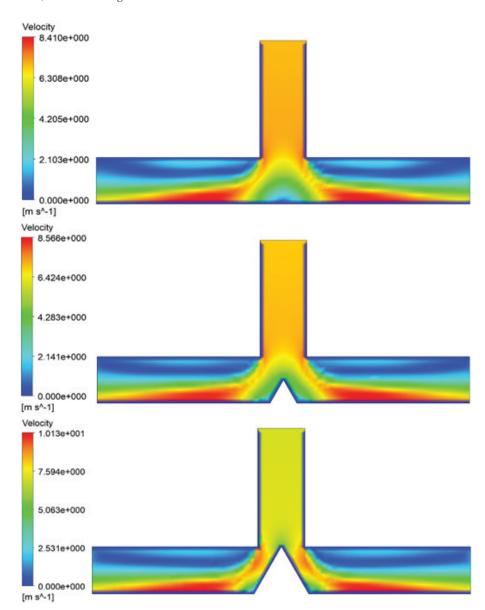
Рис. 2. Распределение скорости (Velocity) по сечению в воздуховоде
