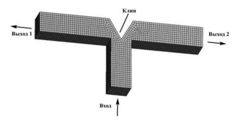
Рис. 1. Часть воздуховода, рассчитываемая методом конечных элементов
