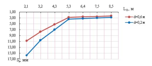
**Рис. 7.** График зависимости дополнительной осадки от расстояния между траншеей и фундаментом  $S_{_3}=f(L_{_0})$  при  $L_{_3}/L_{_0}=0.25;\,H_{_3}/H_{_{\rm T}}=1.0;\,a/d=2.0$
