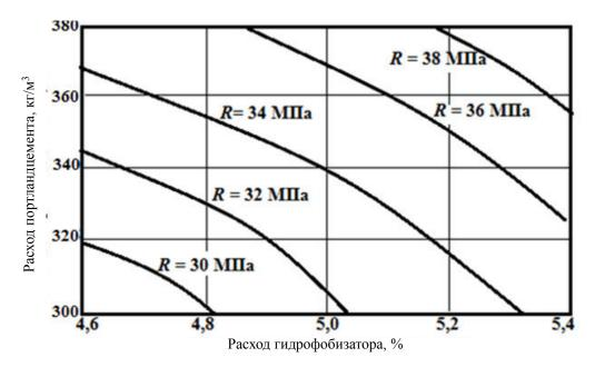
**Рис. 1.** Зависимость прочности бетона от расходов портландцемента и полимерной добавки при содержании пластификатора  $1,15 \pm 0,2~\%$
