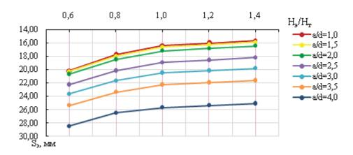
**Рис. 5.** График зависимости дополнительной осадки от относительной глубины экрана  $S_3 = f(H_3/H_{_{
