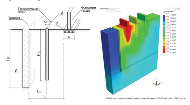
**Рис. 2.** Разработка траншеи при наличии защитного экрана: а) расчетная схема; б) изополя деформаций по оси Z
