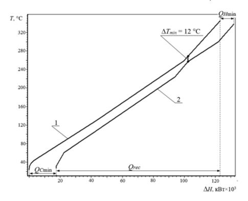
**Рис. 2.** Составные кривые для оптимального температурного напора: 1 – горячих потоков; 2 – профиль холодных потоков
