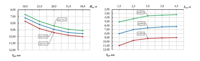
**Рис. 3.** График зависимости дополнительной осадки: a)  $S_{pl} = f(H_{sc})$  при d=0,6 м, a/d=2, E=15 МПа; б)  $S_{pl} = f(L_{sc})$  при a/d=2,  $H_{sc}=30$  м,  $L_{sc}=2$  м, E=15 МПа
