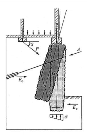
Рис. 1. Расчетная схема грунтоцементных свай и грунтобетонной подпорной стенки, служащих ограждением котлована возводимого здания и усилением основания
