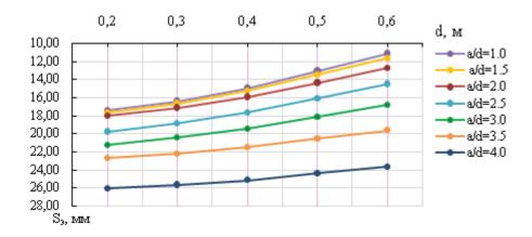
**Рис. 4.** График зависимости дополнительной осадки от диаметра свай экрана  $S_{_3}=f(d)$  при  $H_{_3}/H_{_{
