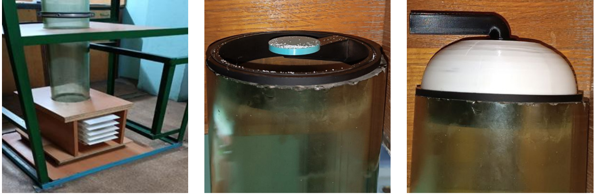
Рис. 1. Фото экспериментальной установки по определению скорости оседания: 1 – седиментатор в виде пластин, на которые осаждаются частицы; 2 – пластина, на которую помещают навеску пыли перед началом эксперимента; 3 – купол с трубкой, с помощью которых пыль приводится во взвешенное состояние для проведения эксперимента
