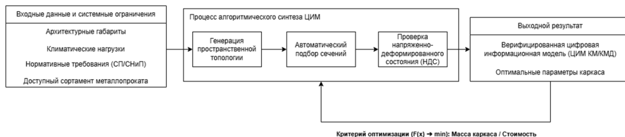
Рис. 1. Основные характеристики процесса автоматизированного синтеза металлических каркасов зданий
