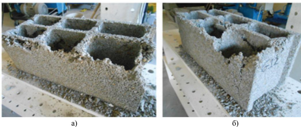
Рис. 3. Испытание блоков на виброплощадке. Характер разрушения блоков:
