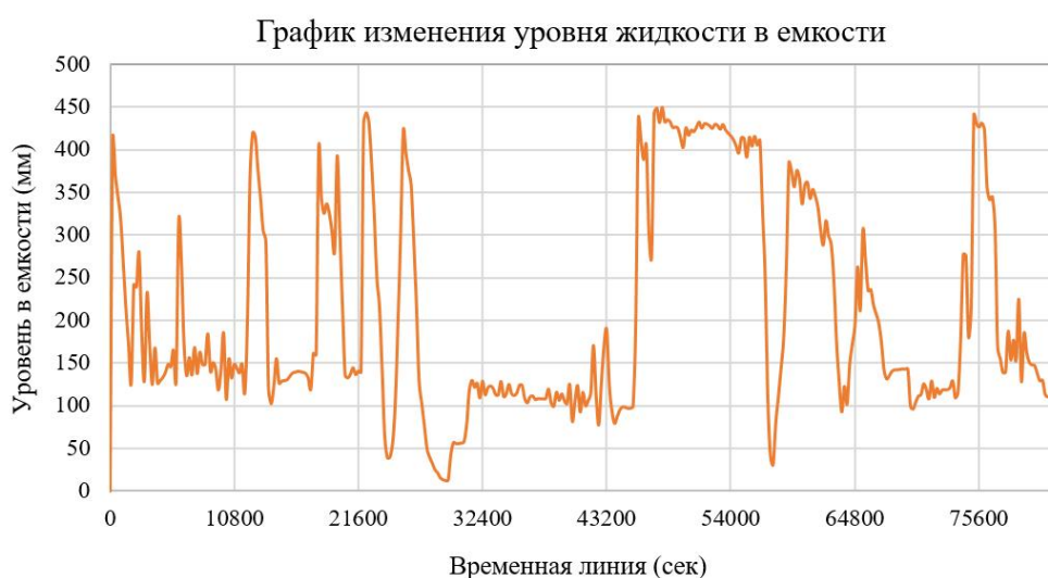
Рис. 4. Изменение уровня в емкости при полуручном управлении
