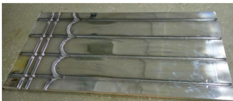
Рис. 2. Исследуемая плита из пенополистирола с полиэтиленовым листом, покрытым тонким слоем алюминия [15]
