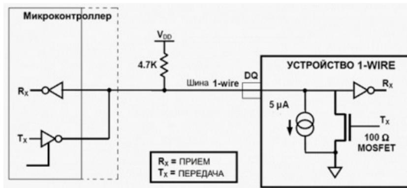
Рис. 2. Подключение устройств 1-Wire в эффективных системах управления «Интеллектуального здания»
