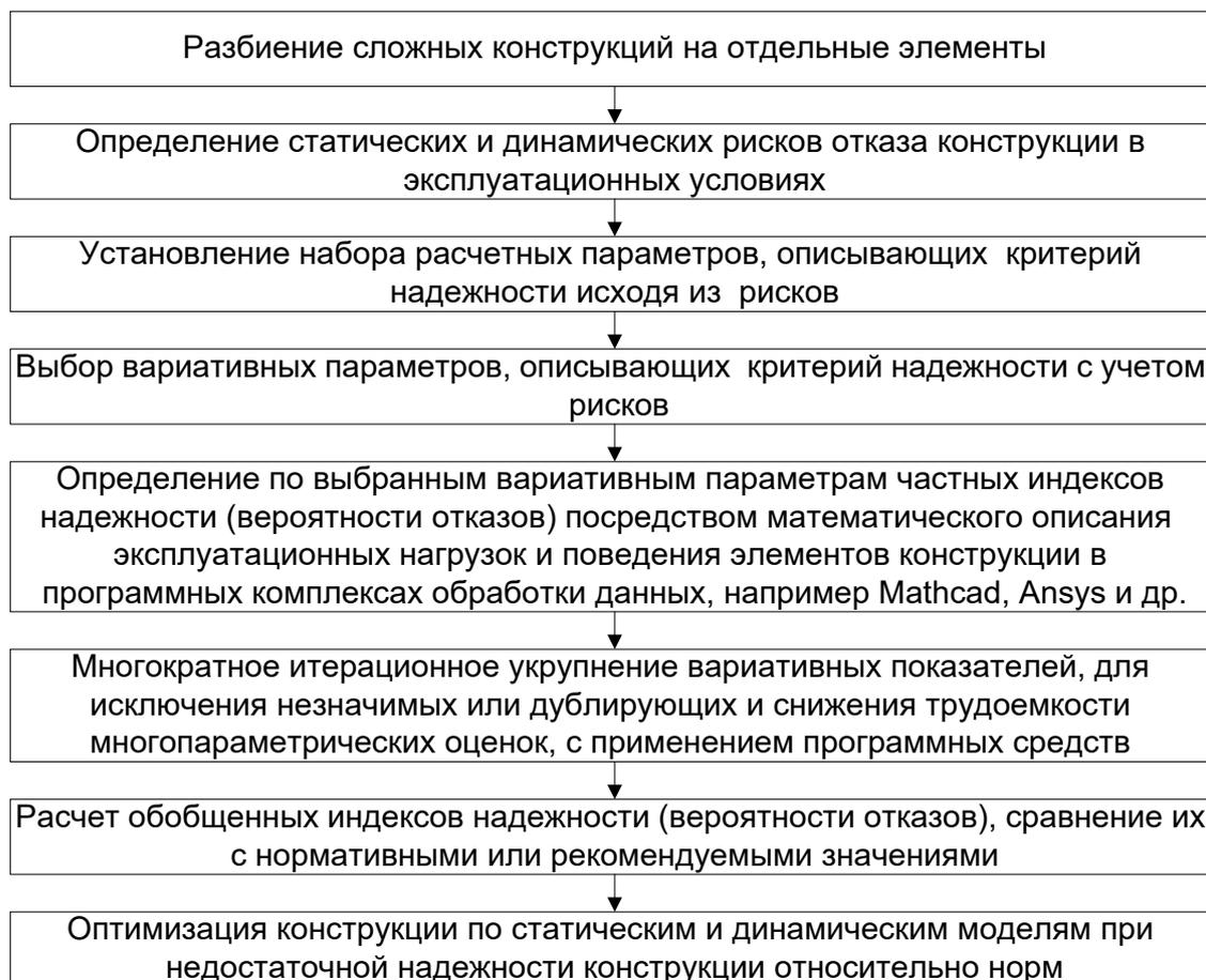
Рис. 1. Алгоритм вероятностной оценки надежности и оптимизации конструкции
