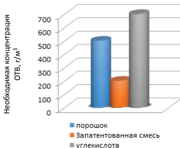
Рис. 1. Синергетический эффект при тушении попутного нефтяного газа в объеме смесью порошка и газа
