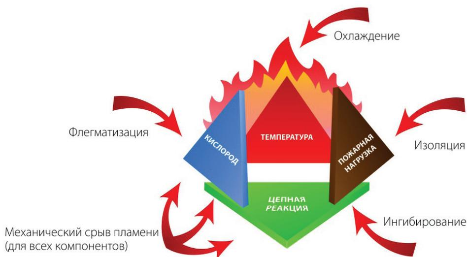
Рис. 2. Воздействие технологии газопорошкового пожаротушения на все грани попутного нефтяного газа
