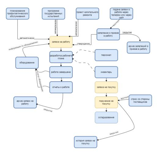
Рис. 2. Базовая блок-схема ЕАМ-системы
