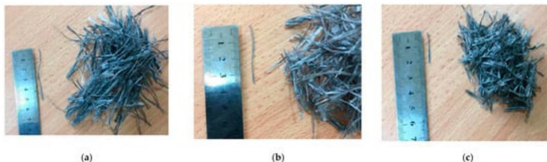
Рис. 4. Различные длины используемого волокна: а) 57 мм; б) 38 мм; в) 19 мм [13]
