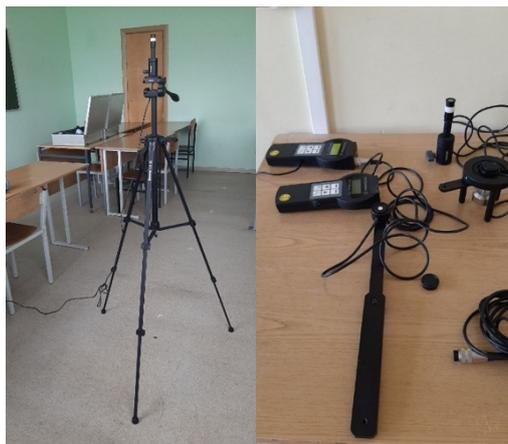
**Рис. 2.** Приборы для измерения цилиндрической освещенности *PRC Krochmann*
