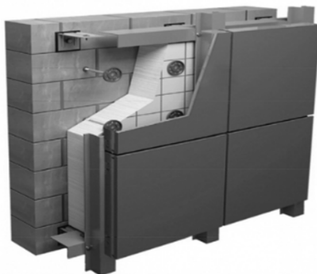
Рис. 1. Устройство НВФ с применением утеплителя
