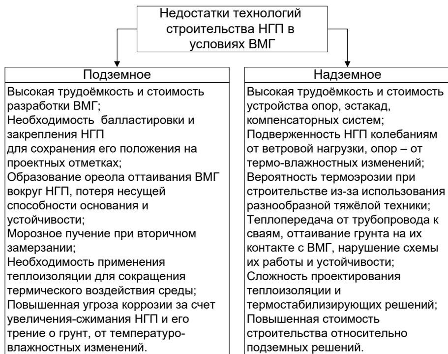
Рис. 3. Проблемы надземного и подземного строительства НГП в условиях ВМГ (составлено автором по данным [4])
