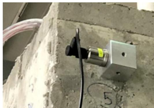
**Рис. 2.** Датчик ускорения (акселерометр)
