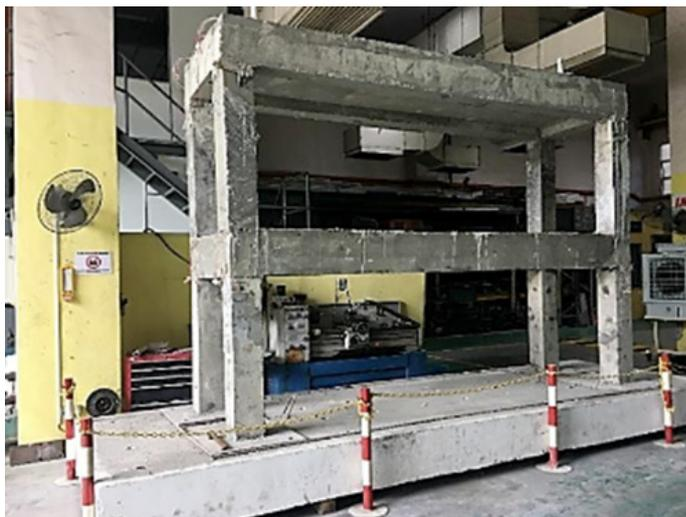
**Рис. 1.** Полуразмерная двухэтажная рама
